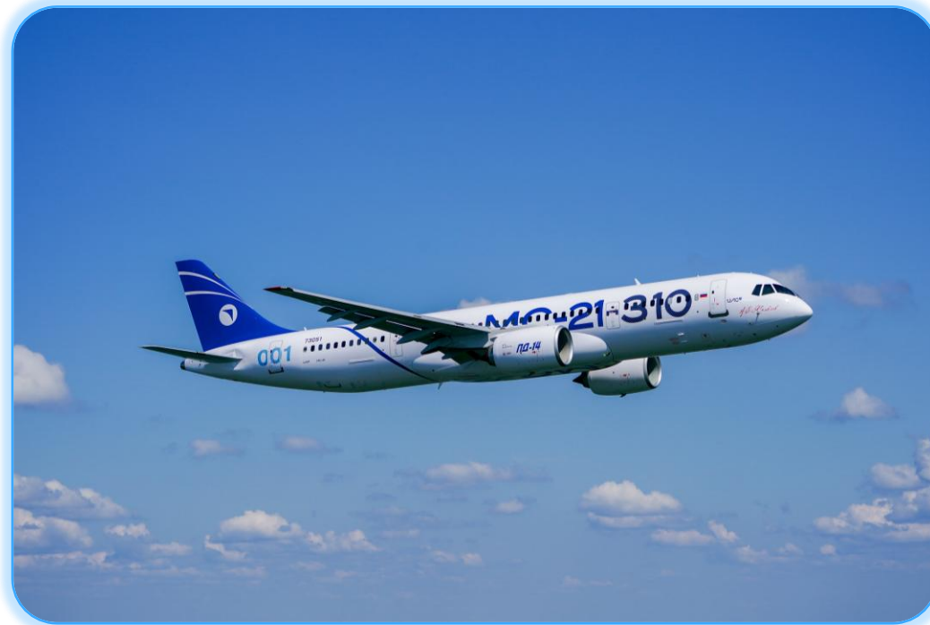
Крыло МС-21 выполнено из современных полимерных композиционных материалов
